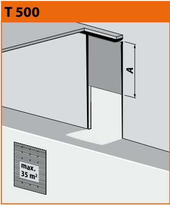
Schienensystem mit Vertikalführung A = lichte Höhe + 560 mm
